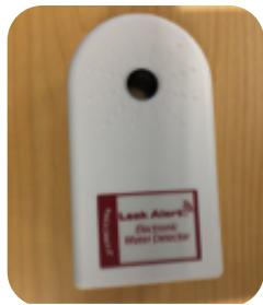
濕漏探測器是用來探測透析機周圍和接駁透析機出水位周圍的漏水情況，亦可探測到透析機的漏血情況。濕漏探測器都是正放在透析機之下。
